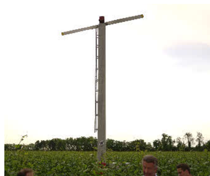
Ein Windrad kann bis zu 6 ha vor Spätfrost schützen.
