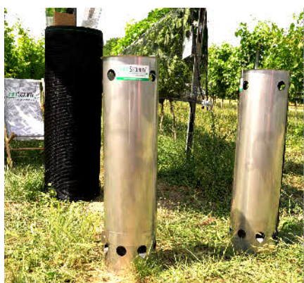
Die neu entwickelten Frostöfen können auch im Obstbau zur Frostabwehr eingesetzt werden. Sie sind mit herkömmlichen Heizmaterial (Holzbriketts bzw. Stückholz) zu betreiben.
