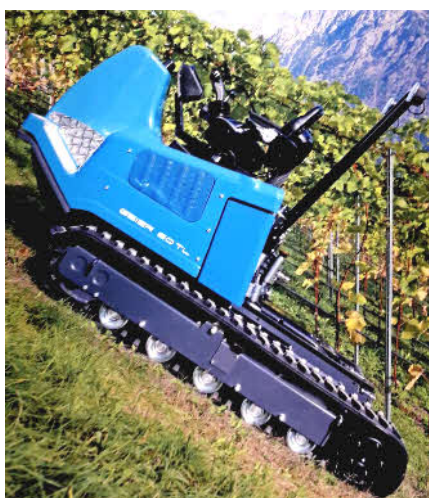
Einsatz in bis zu 80% steilem Gelände einer Raupen der Firma Geier.
