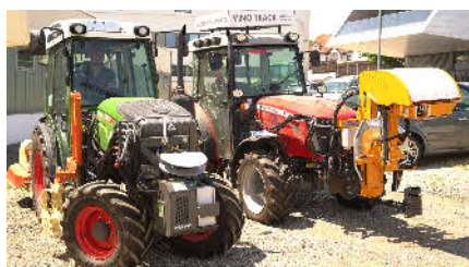
Zwei autonome Systeme im direkten Vergleich, links die autonome Steuerung von Anbaugeräten, der Traktor wird vom Fahrer gelenkt. Rechts der autonom gesteuerte Traktor, die Anbaugeräte werden vom Fahrer gesteuert.
