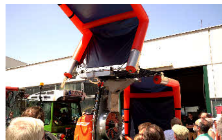
Der aufblasbare Rebenschirm soll nächstes Jahr in Serie gehen und ist hochklappbar.
